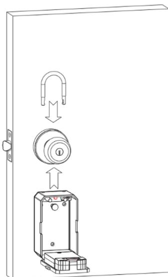
Inserte el grillete en el agujero en la parte superior de la caja de llaves, enganchar con una cerradura, tubo, barra metálica o cualquier objeto fijo y seguro.
